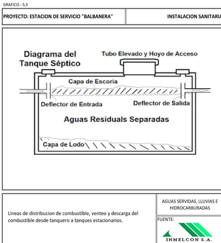
Gráfico No. 19. Instalación Tanque Séptico de la Estación de Servicio "BALBANERA"
